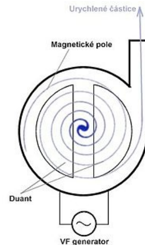
Schematické znázornění cyklotronu
