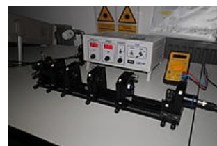
Pevnolátkový laser (Nd-YAG)
